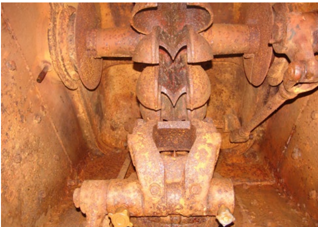
Вид рабочего колеса Pelton с соплом и отражателем струи, Briegleb & Hansen, 1914 г., состояние 2024 г.
