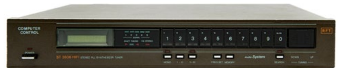
Синтезатор-тюнер с ФАПЧ «СТ 3936»: много электроники, мало механики и высокая цена
