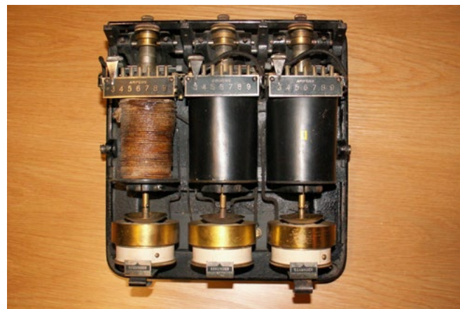
Рис. 14. Защита от сверхтоков TCB, ASEA, 1905 г.
