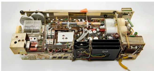
Шасси «Transstereo 2401»: вверху слева — конденсатор переменной емкости для AM-диапазона с прикрепленным снизу FM-модулем; внизу слева стереодекодер; Вверху посередине - плата ВЧ, под ней - плата ПЧ-НЧ, справа внизу - пластины охлаждения транзисторов силового каскада и силового трансформатора.
