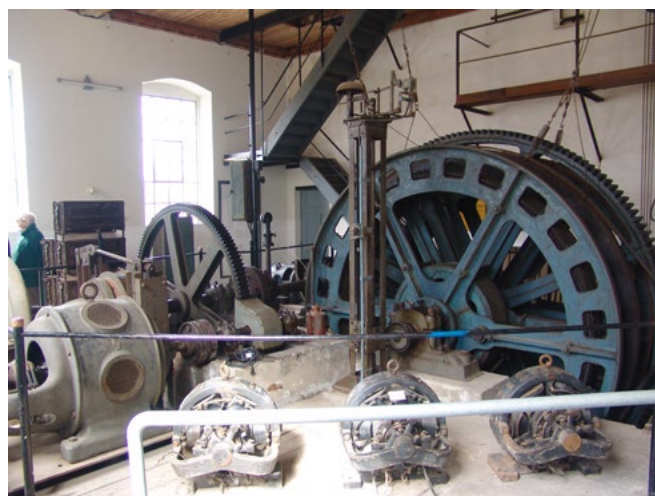
Старая намоточная машина на шахте «Три брата», на переднем плане три возбуждителя с подстанции, 2024 год.
