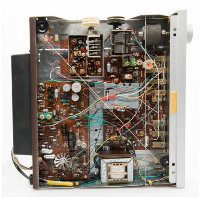
Шасси «СТ 3000»: вверху слева FM-модуль, справа переменный конденсатор AM; Слева плата декодера, справа плата ВЧ-ПЧ.
