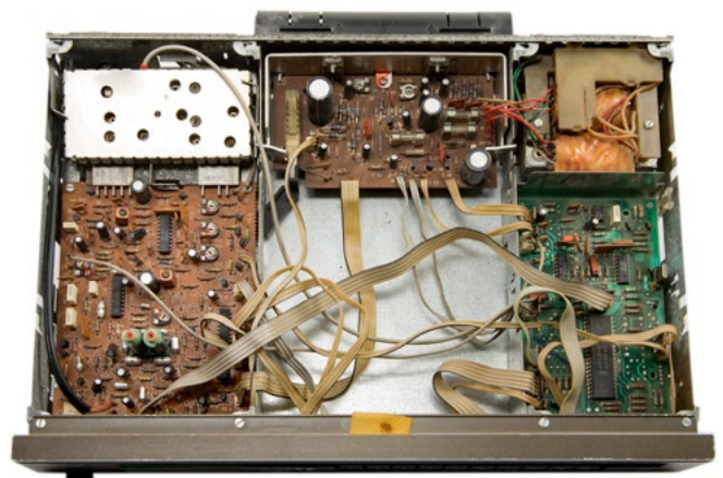
Шасси «СТ 3936»: вверху слева — модуль УКВ, под платой ПЧ, вверху посередине и справа — блок питания, под платой ФАПЧ компьютера.
