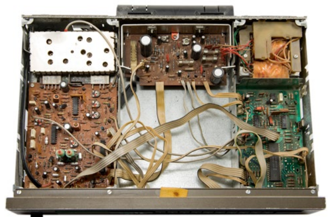
Chassis des „ST 3936“: oben links die UKW-Baugruppe, darunter die ZF-Platine, oben Mitte und rechts das Netzteil, darunter die Rechner-PLL-Platine
