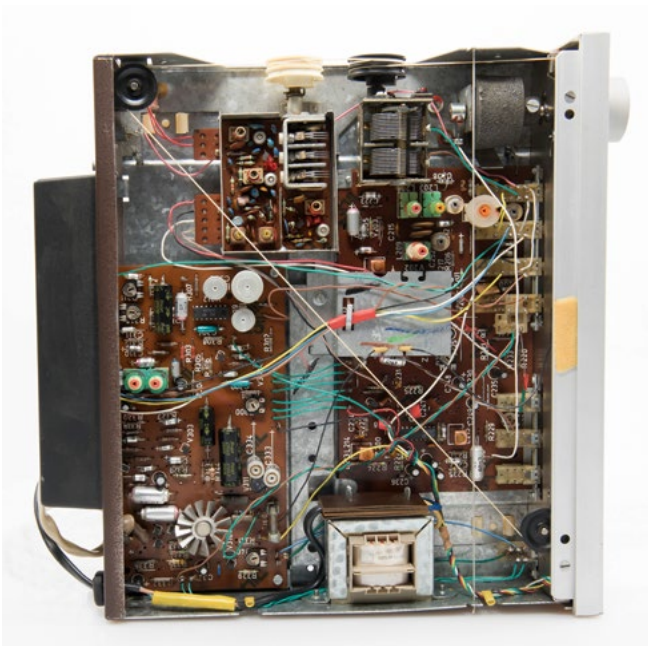
Chassis des „ST 3000“: oben links die UKW-Baugruppe, rechts daneben der AM-Drehkondensator; links die Decoder-Platine, rechts die HF-ZF-Platine
